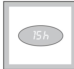
Время задержки появляется на 3 секунды, после чего высвечивается продолжительность выбранной программы. После нажатия кнопки СТАРТ/ПАУЗА начинается отсчет, и значение задержки уменьшается на одну единицу в час. Задержку включения выбранной программы можно отложить до 24 часов с интервалами в один час.
